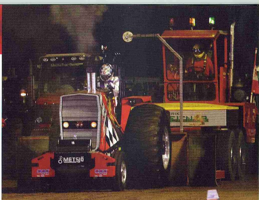
De trekker tijdens het optoeren in Bakel. Hier kwam hij niet weg omdat de overbrengverhouding te groot was.
