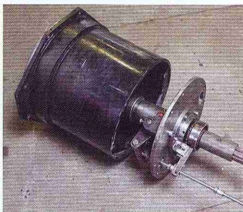
Het team ontwikkelde een rem voor de aandrijf-as. Deze zit vlak achter de koppeling.
