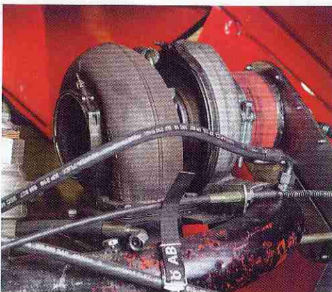
De trekker is voorzien van een flinke turbo. Links de inlaat voor warme lucht.
