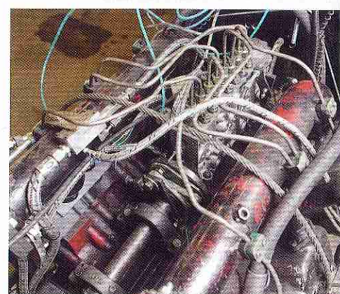
Twee lagerblokken ondersteunen de aandrijfas van de brandstofpomp.
