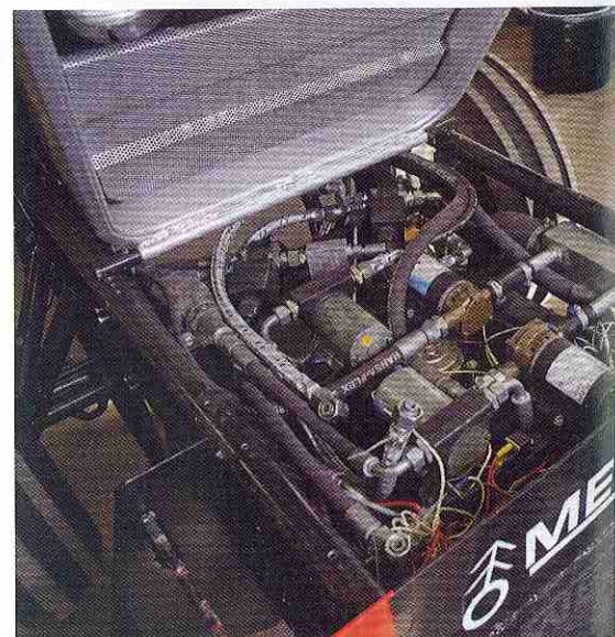
De elektrisch aangedreven pompen kregen een plaatsje op de neus van de trekker.
