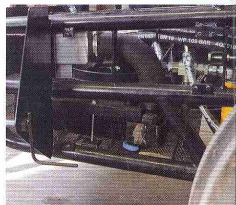
De koeling is horizontaal gemonteerd, onder de elektrische pompen.
